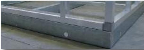
basamento è realizzato mediante l'accoppiamento di un profilato di lamiera zincata spessore 30/10 laminato a freddo con angoli saldati in lamiera zincata 30/10 e altezza 180mm. A richiesta è possibile fornire dei piedini di supporto di altezza variabile, da definirsi in fase di ordine, abbinabili sia a una base continuo, sia come unico punto di appoggio della CTA.
