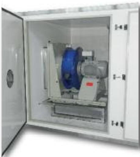
Tutti i telai portanti di filtri, batterie e ventilatori sono "annegati" all'interno della pannellatura rivestita in vetroresina, per limitare al minimo la presenza di elementi di intralcio al flusso dell'aria e alle operazioni di sanificazione e pulizia. Le superfici interne perfettamente lisce e prive di viti a vista.
