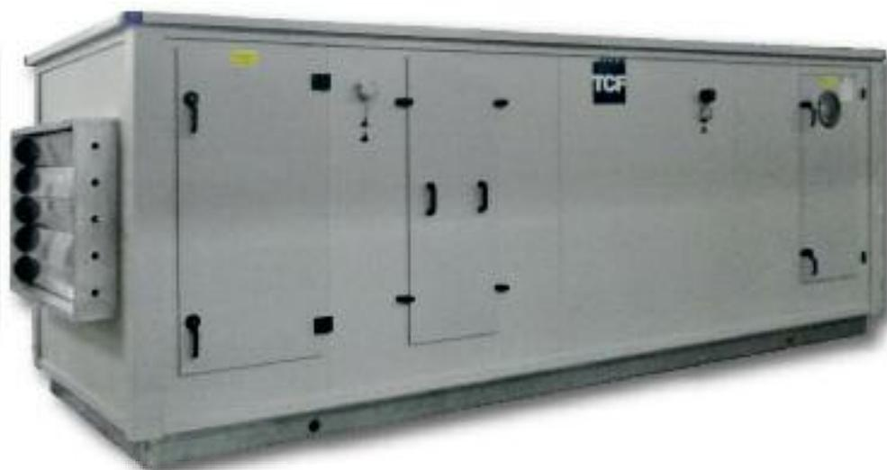
■ **Basamento** perimetrale, esso costituisce un appoggio perimetrale continuo delle unità e permette di scaricare il peso su una superficie maggiore sollecitando al minimo le strutture su cui vengono posate le nostre unità. Il basamento è realizzato mediante l'accoppiamento di un profilato di lamiera zincata spessore 30/10 laminato a freddo con angoli saldati in lamiera zincata 30/10 e altezza 180mm.
