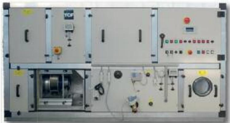
L'intero sistema di regolazione e potenza, viene installato e cablato a bordo macchina presso il nostro stabilimento per poi essere collaudato prima della spedizione in cantiere. Il quadro elettrico di regolazione e potenza viene realizzato in cassa metallica (IP65). Il visore LCD retroilluminato e le spie di segnalazione permettono un'immediata visualizzazione dello stato della UTA.
