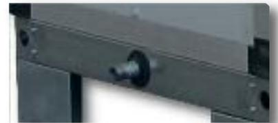
■ **Portine di ispezione** realizzate con lo stesso processo di formazione delle altre pannellature e negli spessori 25mm e 50mm a seconda del tipo di profilato impiegato, e con lo stesso materiale di isolamento (poliuretano o lana minerale). Le porte sono fissate al telaio mediante un sistema di apertura con maniglie e cerniere, oppure con
