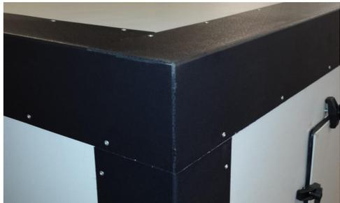
Il **basamento** costituisce un appoggio perimetrale continuo delle unità e permette di scaricare il peso su una superficie maggiore sollecitando al minimo le strutture su cui vengono posate le nostre unità. Il basamento con altezza 180mm è costruito in lamiera da 30/10 sagomata e saldata ad angolo.
